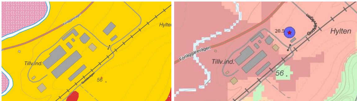
Fig. 5. Jordartskarta (gul färg: glacial lera) samt jorddjupskarta från SGU, med huvudsakligt djup ca 20 - 30 m.
